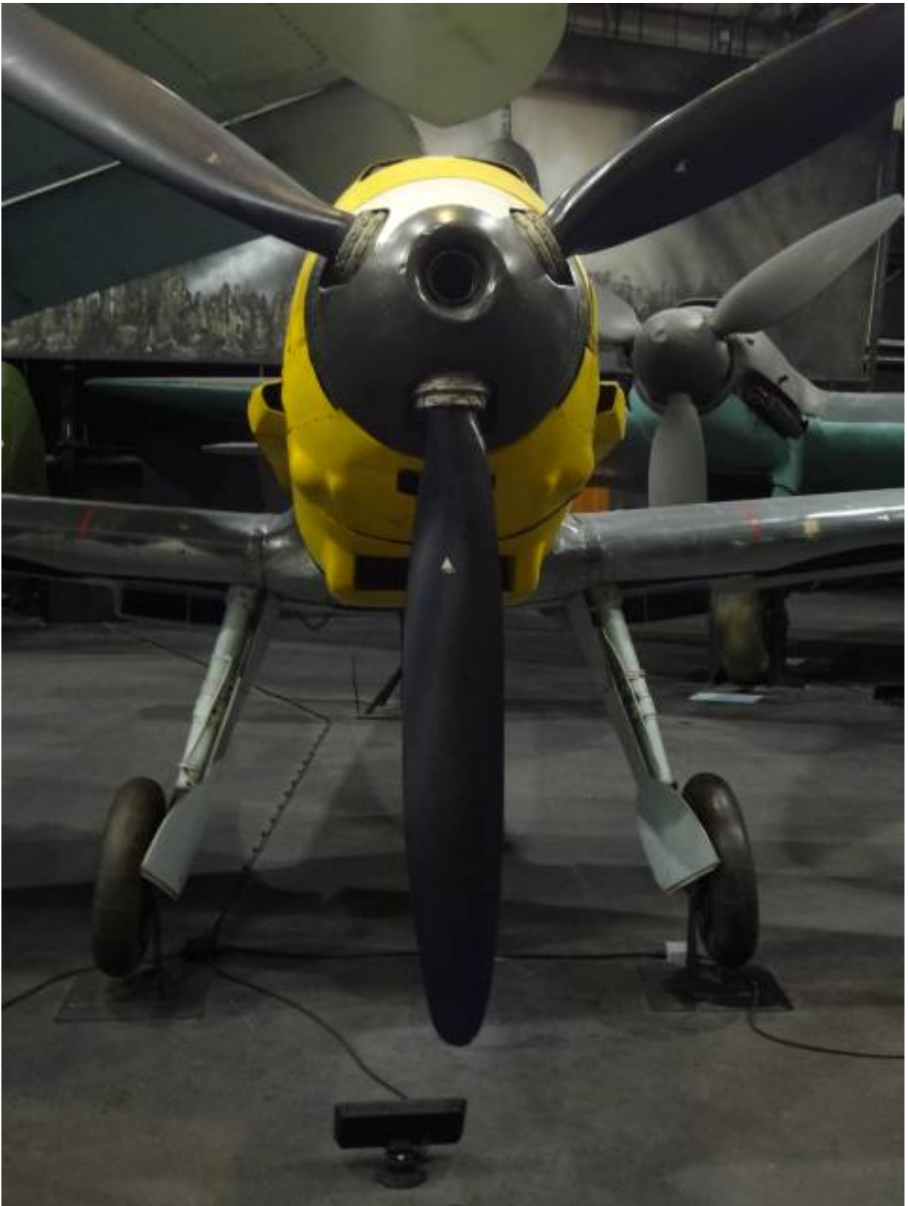
Messerschmitt Bf109E med sitt smalspåriga ställ. RAF Hendon.
